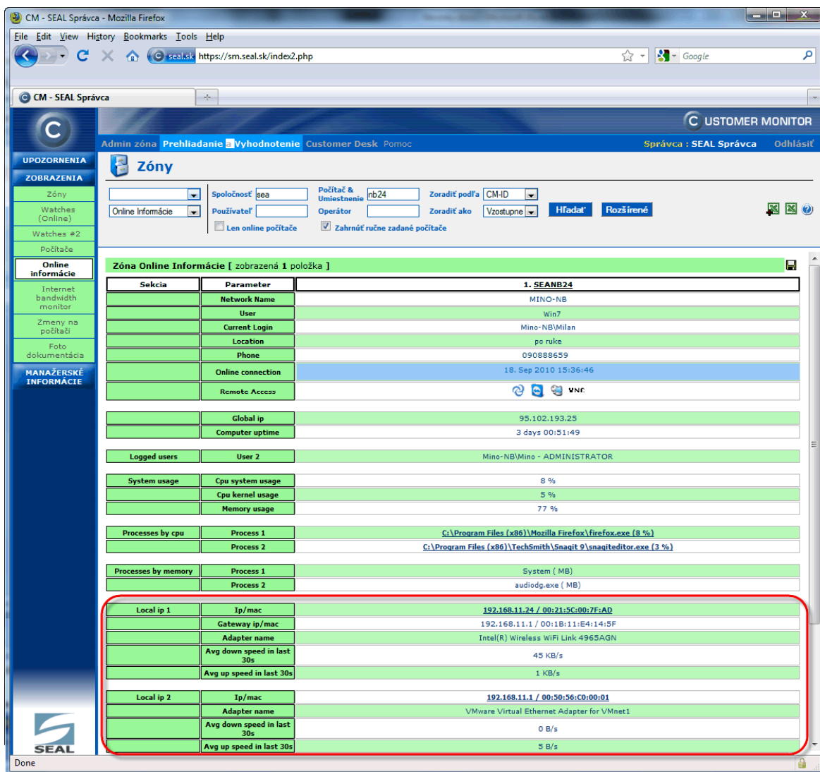
Obrázok č. 57 Aktívne sieťové adaptéry v Online informáciách - s názvom adaptéra a MAC adresou
